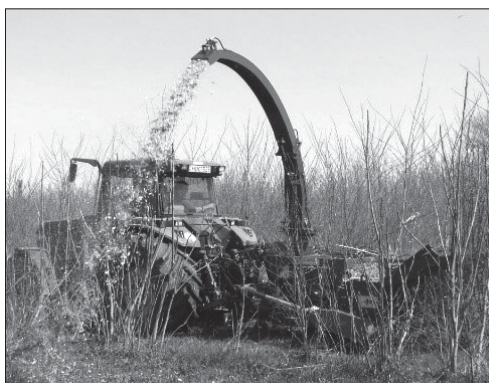
Energetikai faültetvény döntő-aprító gép vizsgálata (2010) (Forrás: Soproni Egyetem fotóarchívuma)
