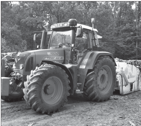
Modern vontatott talajmaró (bal) és kötőanyag adagoló (jobb)
