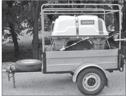
Az erdőgazdaságnál rendszerbe állított VÍZÖNTŐ erdőtűz-oltó berendezés (2006) (Forrás: Soproni Egyetem fotóarchívuma)
