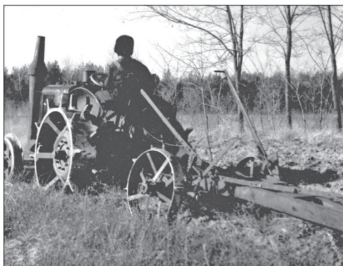
Körmös traktor erdősisítés talajelőkészítésében (1950) (Forrás: ERTI fotóarchívuma)
