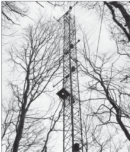
A 30 m magas Brennberg-hermesi mérőtorny a 2004-ben felszerelt szenzorokkal. Segítségével hazánkban először tartták fel a bükkös faállományban lezajló sugárzás- és hőháztartási folyamatokat (Fotó: Vig Péter)
