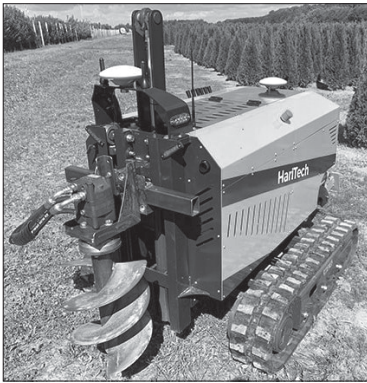
Hazai fejlesztésű és gyártású gödörfúró robot (Forrás: Hári Tech Kft.)
