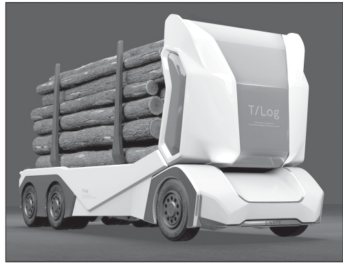
A „T-Log” vezető nélküli erdészeti terepjáró tehergépkocsi rakottan (2018) (Forrás: Einride Co.)
