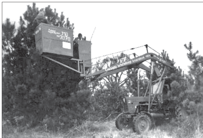
Az acsádi fenyőültetvény toboztermésének begyűjtésére konstruált hidraulikus adapter, csuklósan igazítható hidakkal (tervezők: Mátyás Cs. és Tiborc S.). Minden előnye ellenére, a szakmai és gazdasági feltételek változásával az adapter használata feleslegessé vált (Fotó: Mátyás Cs., 1983)
